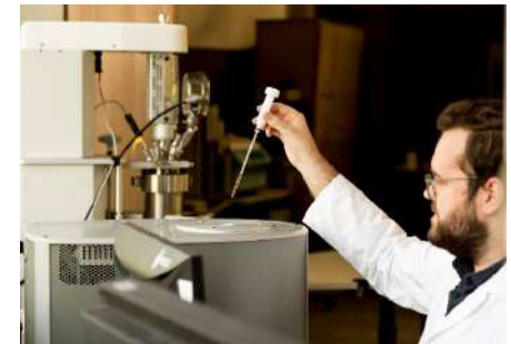
René Burger analysiert Lignine mittels 1H Benchtop-NMR-Spektroskopie
