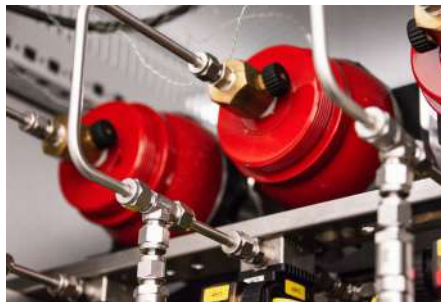
Metallhydridspeicher im Inneren
