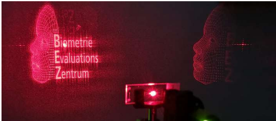
Laboraufbau zur Validierung des HOEs.
