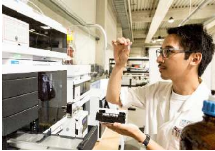
Xuan Tung Do untersucht Biopolymere mittels 2D SEC/RPLC
